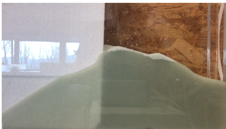
Obrázek A.2: Fotografie akvária při zmenšeném objemu polystyrenem s 400–600mm kuličkami
