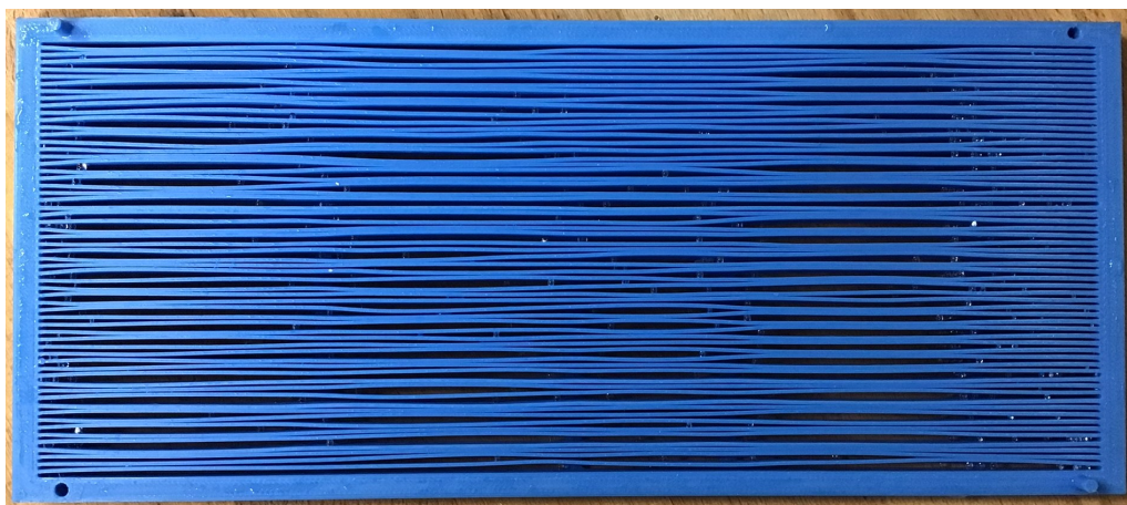
Obrázek 5.5: Zdeformovaná puklina vlivem tlaku kuliček, které se dostaly mezi lamely při měření
