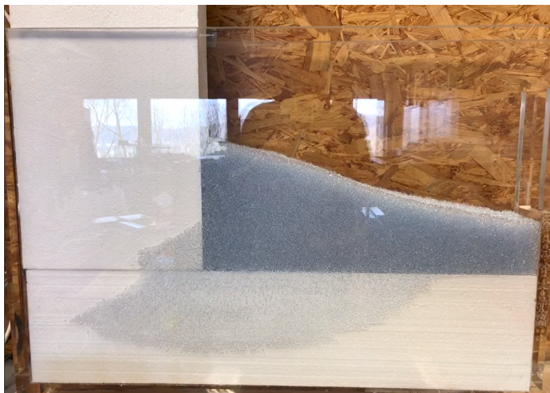
Obrázek A.1: Fotografie akvária při zmenšeném objemu polystyrenem s 3mm kuličkami
