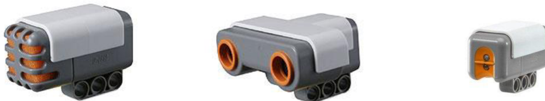
Obrázek 5: Digitální čidla. Zleva: čidlo zvuku, ultrazvukové čidlo vzdálenosti, optické čidlo vzdálenosti. [4]
