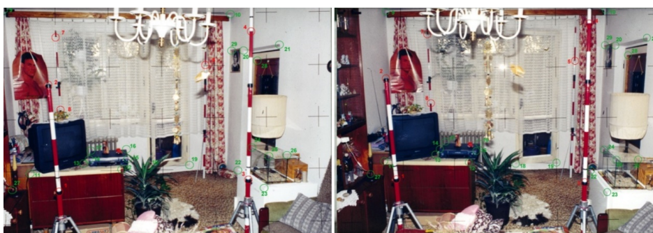
Obrázek 28. – Více snímková fotogrammetrie levý a pravý snímek pokoje. Zdroj: ŠVARC, Petr. Prezentace. Topografická dokumentace. [cit. 2023-02-21].
