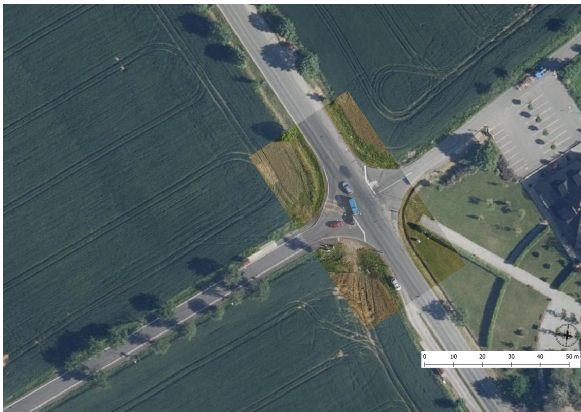
Obrázek 27. – Fotogrammetrická dokumentace dopravní nehody. Zdroj: Policie České republiky, Krajské ředitelství Středočeského kraje, 2020
