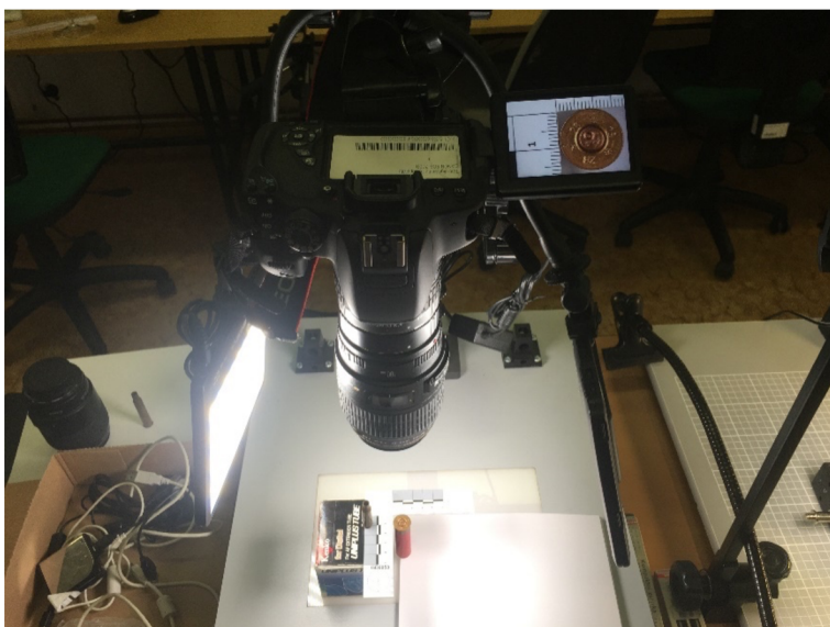
Obrázek 31. – Pořizování makrofotografie nábojnice. Zdroj: LEGIERSKI, 2020
