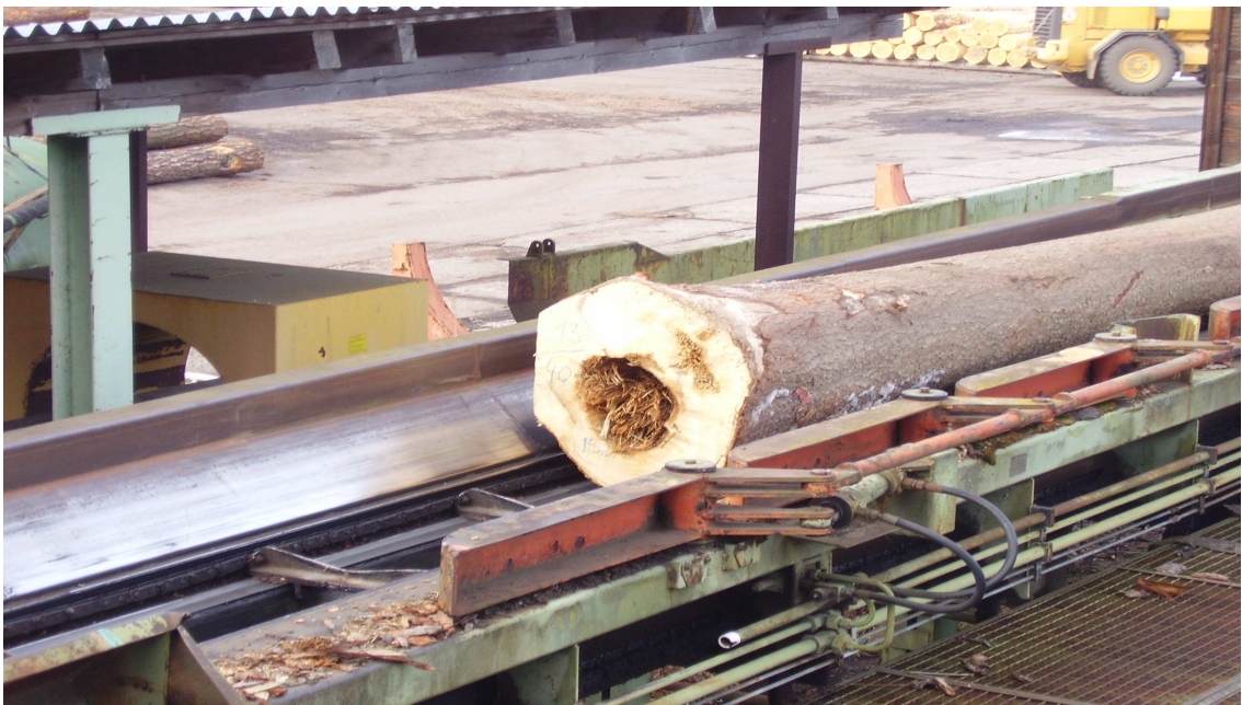
Obrázek 2- Poškozená kulatina před manipulací
