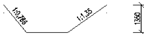
Obr. 22 Schéma profilu koryta v místě mostu 1A pro ovlivněné proudění hl. dolní vody
