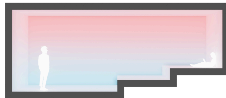
Teplotní gradient neupravovaného prostředí 1, s.61
