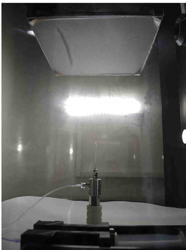
Obrázek 6: Fotografie emitru a kolektoru 4SPINu při zvlákňování polymerního roztoku HA/PEO.
