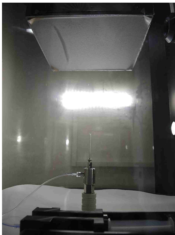
Obrázek 6: Fotografie emitoru a kolektoru 4SPINu při zvlákňování polymerního roztoku HA/PEO.
