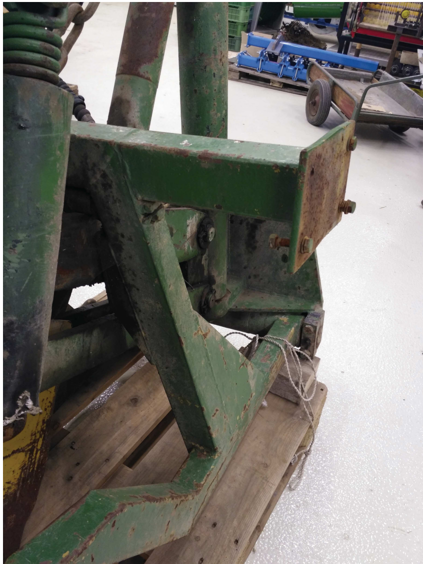
Obrázek 12: Detail původního neupraveného nosného ramene na RZS-1.
