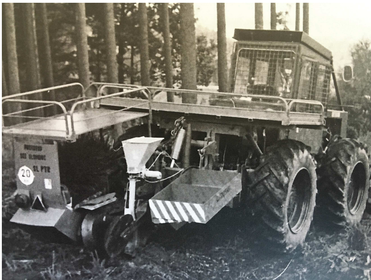
Obrázek 4: Rýhovací zalesňovací stroj s přidavným přihnojovacím zařízením nesený lesnickým kolovým traktorem (Simanov, 2015).
