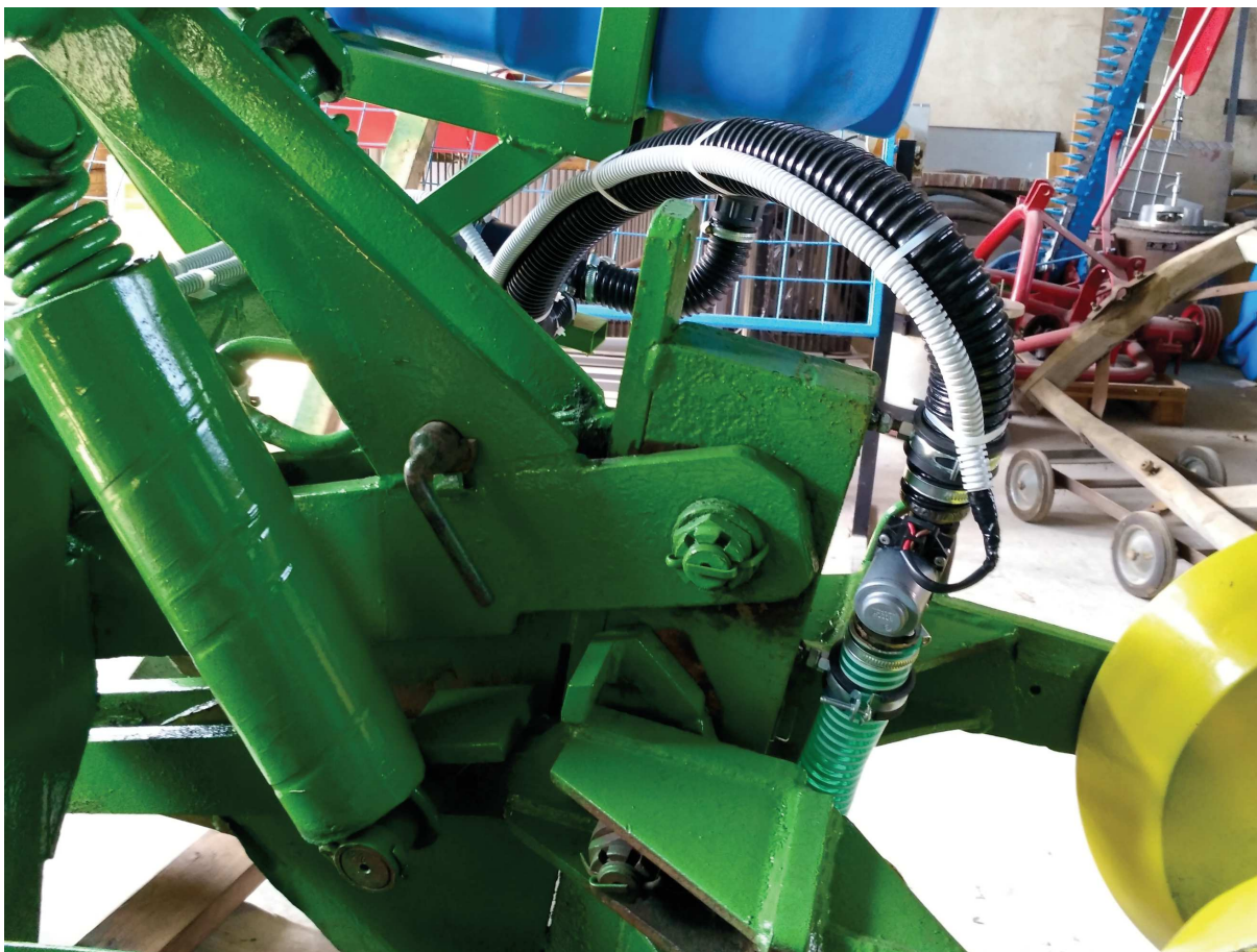
Obrázek 9: Speciálně navržený elektroventil namontovaný na stroji.
