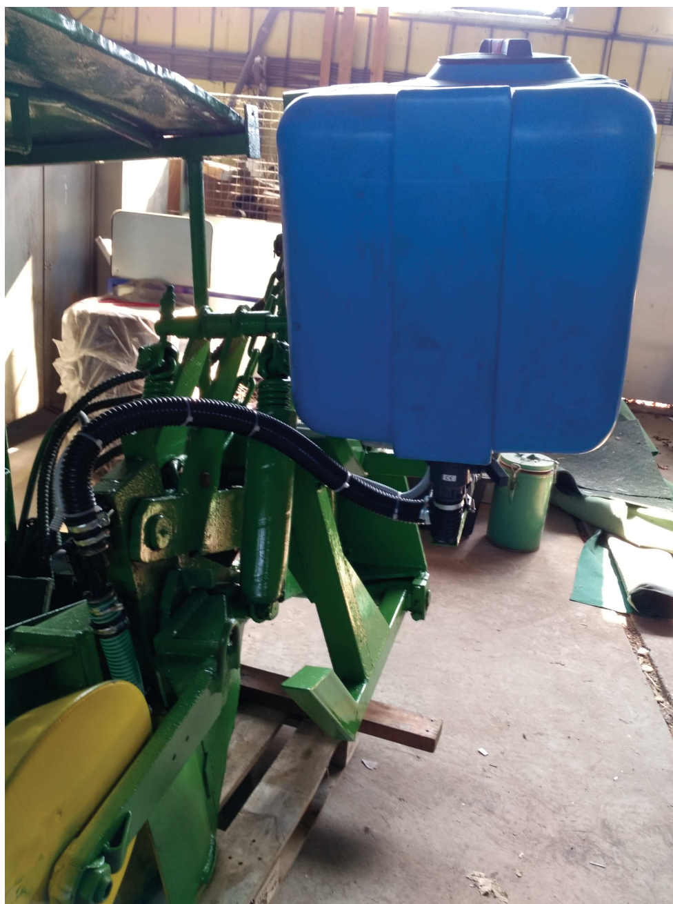
Obrázek 13: Plastová nádrž připevněná na upraveném a vyztuženém ramenu.
