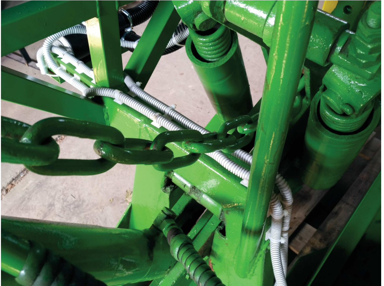
Obrázek 14: Zrenovované zvedací zařízení rýhovacího zalesňovacího stroje RZS-1.
