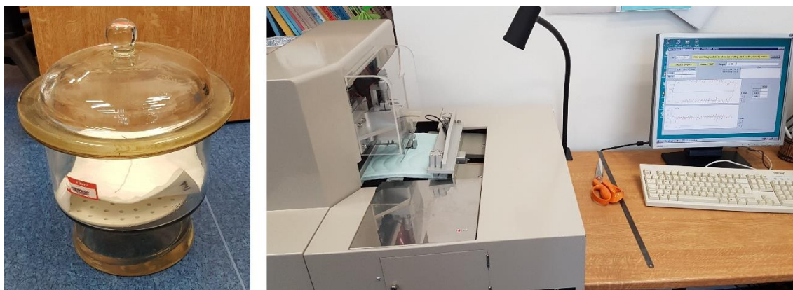
Obr. 23 - Vzorek v explikátoru a měření na přístroji KES-FB4.
