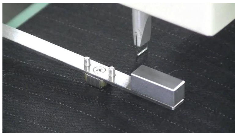
Obr. 11- Snímače přístroje KES-FB4. [38]
