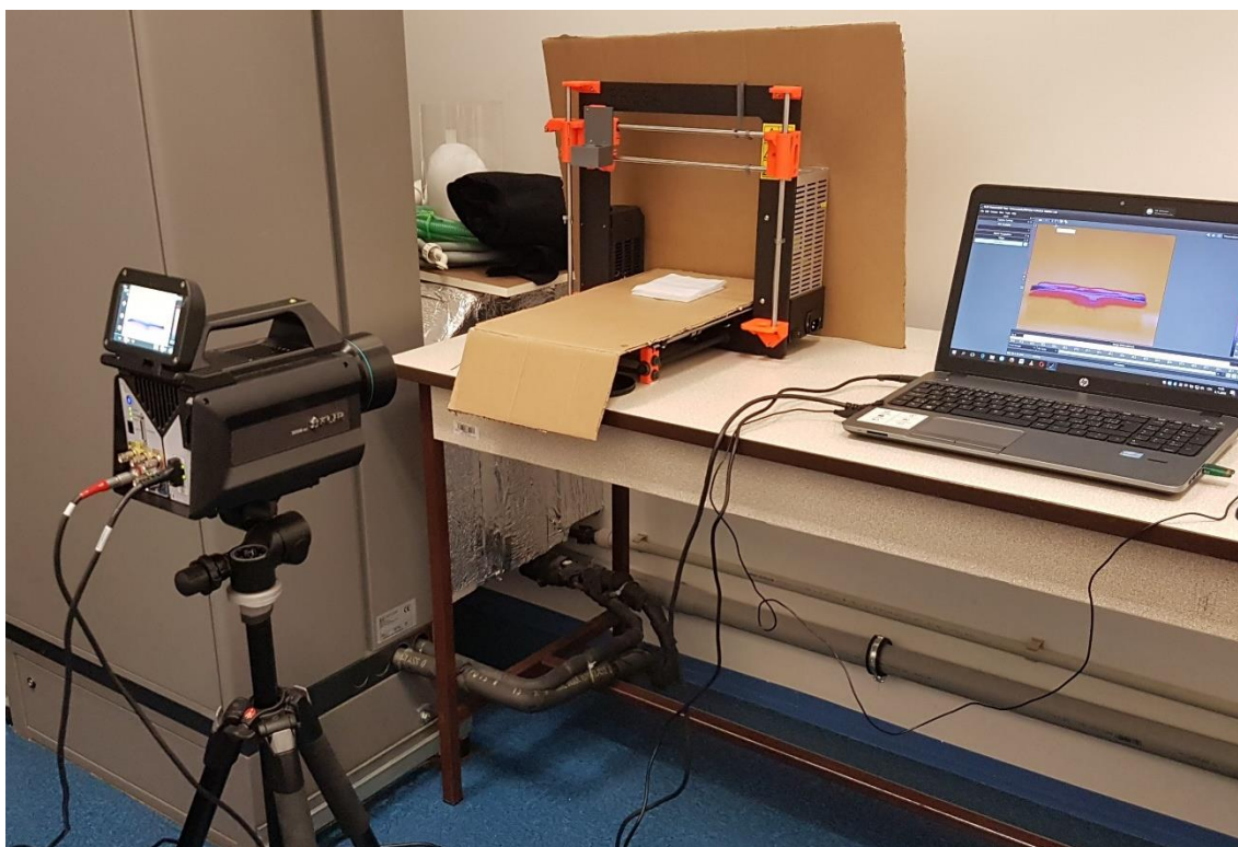
Obr. 29 - Umístění termokamery při experimentu.
