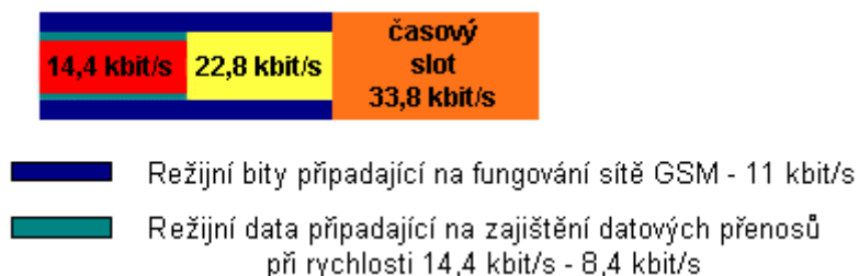
Obrázek 13 -Režijní bity – při rychlosti 14,4 kbit/s – 8,4 kbit/s [27]
