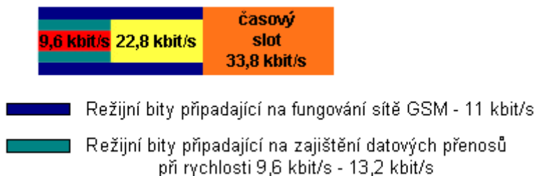
Obrázek 12 - Režijní bity – při rychlosti 9,6 kbit/s – 13,2 kbit/s [27]
