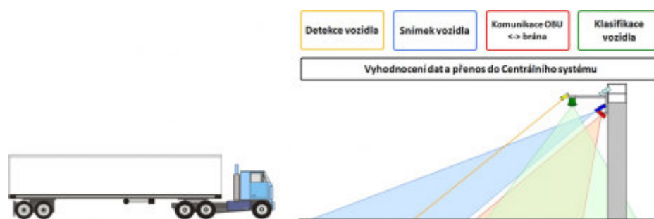
Obrázek 6 - Schéma funkce kontrolní mýtné brány [17]
