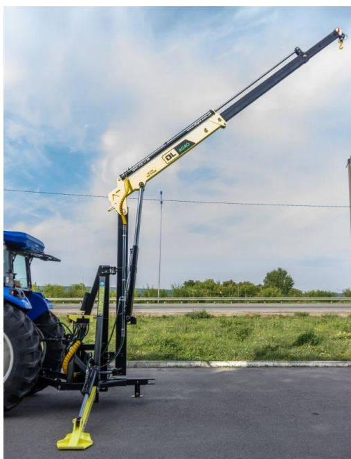
Obr. 3 Jeřáb DL Agro při svém plném vysunutí výložníku [7]
