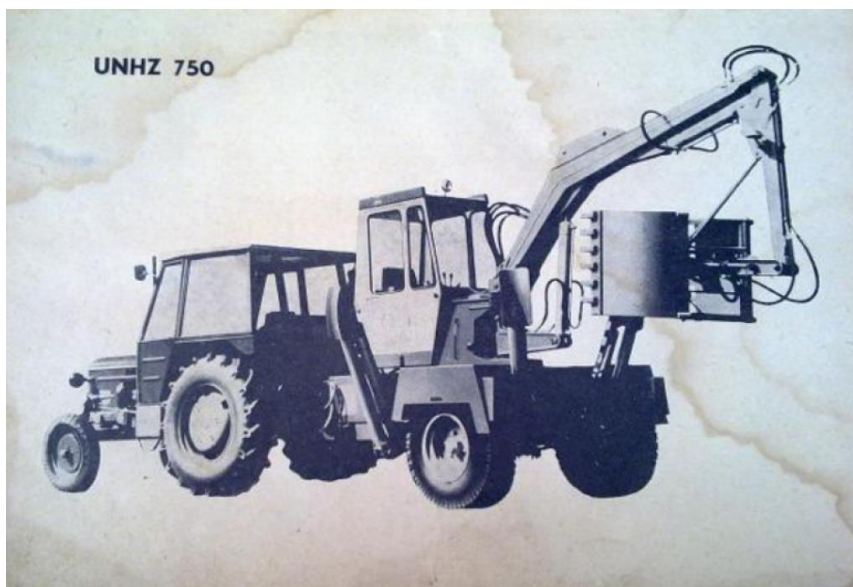
Obr. 1 Dříve hojně využívaný univerzální hydraulický nakladač UNHZ 750 [3]
