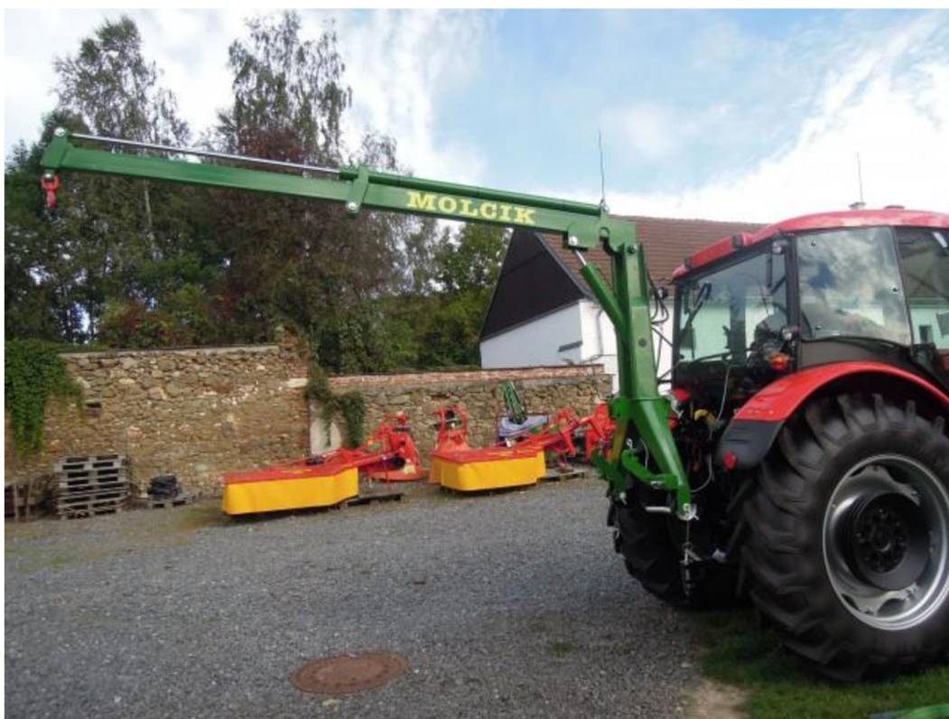
Obr. 7 Hydraulické rameno HRM 1,5 v agregaci s traktorem Zetor Proxima [13]
