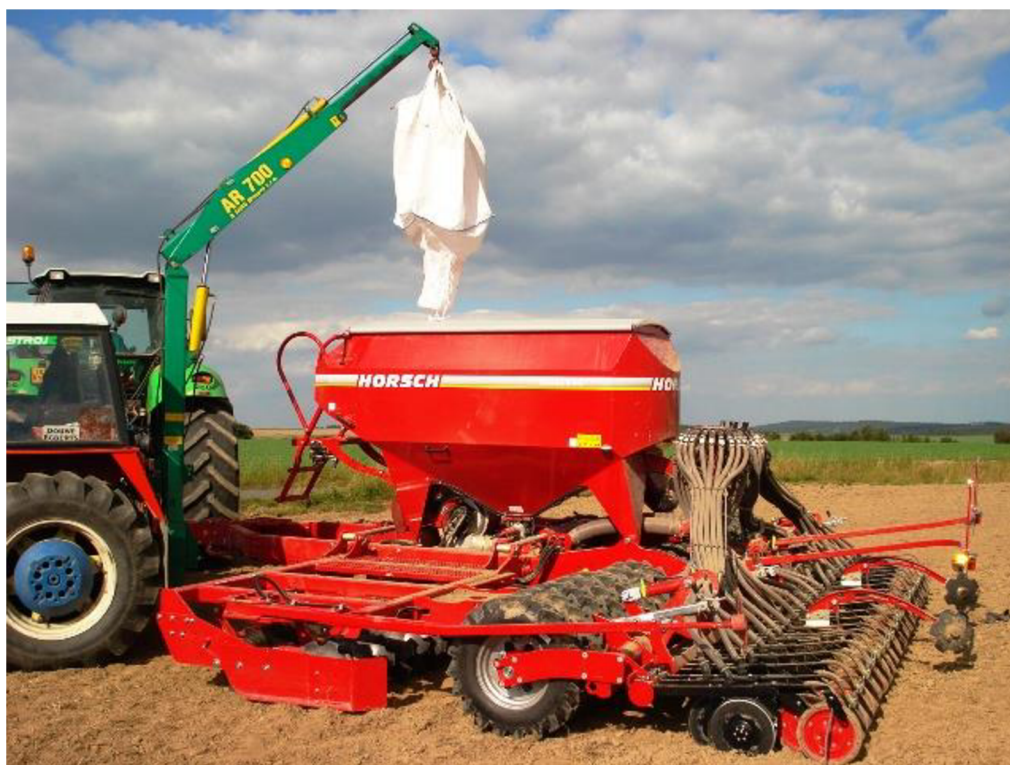
Obr. 6 Plnění secího stroje je typickým příkladem pro využití ramena AR 700 [12]
