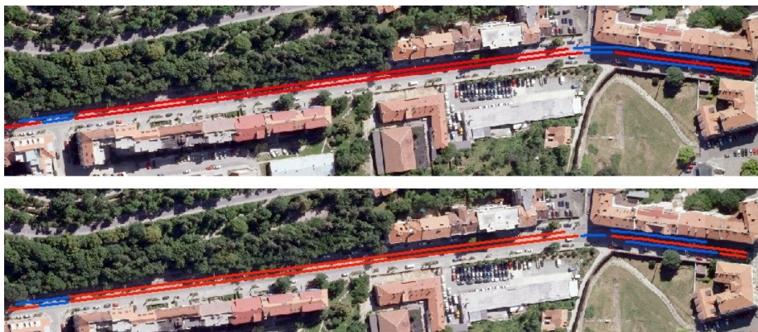
Obrázek 56: Porovnání identifikace čar na rovném úseku (dole) s daty vytvořenými v programu ArcMap (nahore). Modrou čarou jsou znázorněny přerušované a červenou plné čáry.
