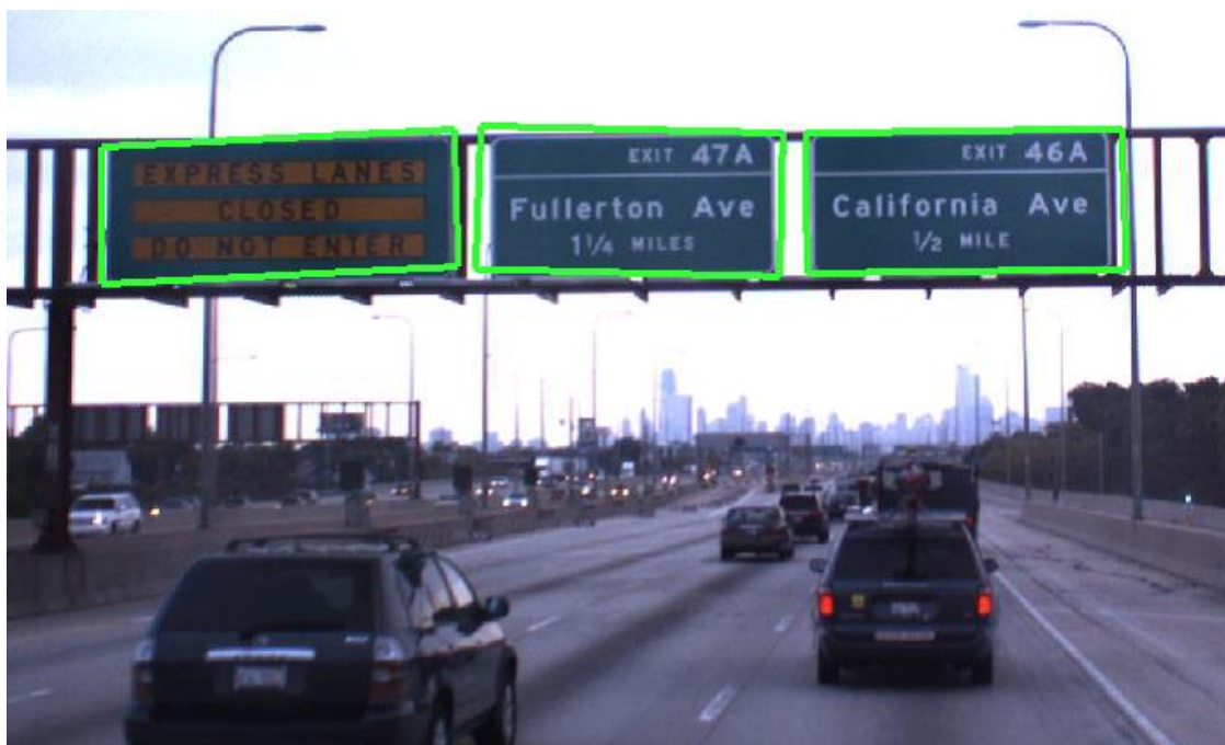
Obrázek 10: Výsledek detekce dopravní značky znázorněný v georeferencovaném obrazu (Chen a kol., 2009).
