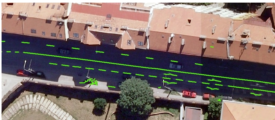
Obrázek 51: Výsledek vytvoření koster z mračna bodů zobrazený nad ortofotomapou.
