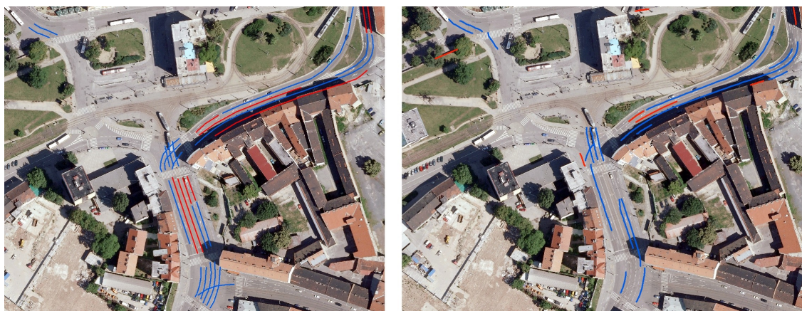
Obrázek 57: Porovnání identifikace čar na úseku s křižovatkami (vpravo) s daty vytvořenými v programu ArcMap (vlevo). Modrou čarou jsou znázorněny přerušované a červenou plné čáry.
