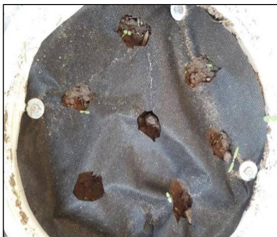
Obr. 9: Otvory v geotextílii pro setí rostlin (zdroj: společná databáze řešitelů projektu VI20192022153)
