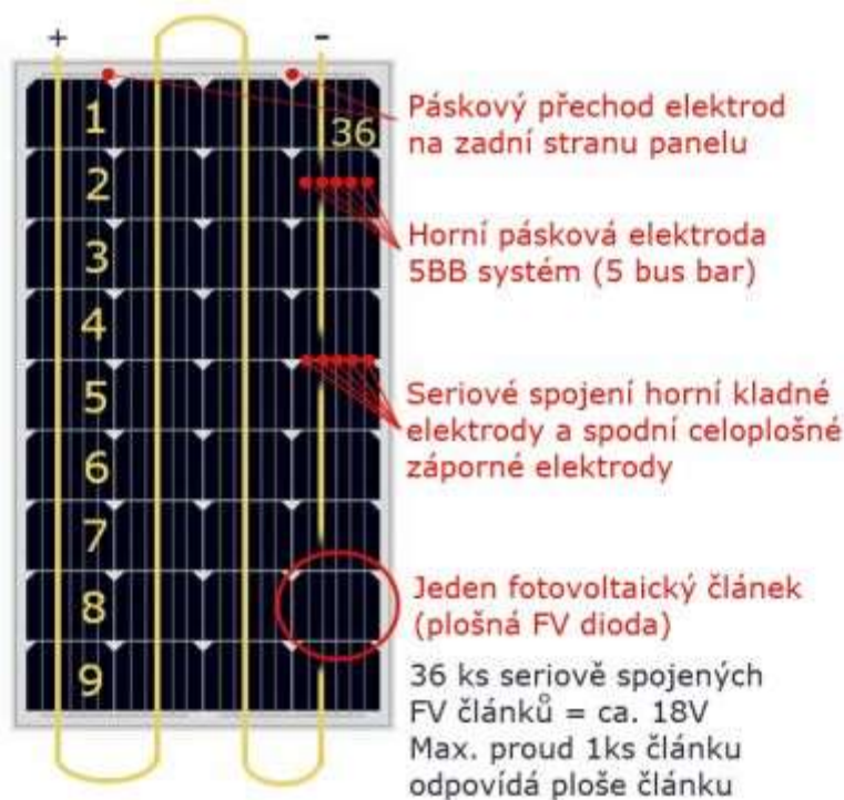
Obr. 20: Fotovoltaický panel (Vselektro, 2024)
