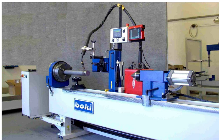
Obrázek 8 - rotační svařovací automat BRP-VP-120 firmy Boki [19]
