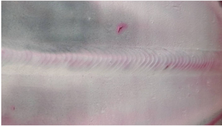
Obrázek 13 - penetrační zkouška na vzorku svařeném metodou GTAW
