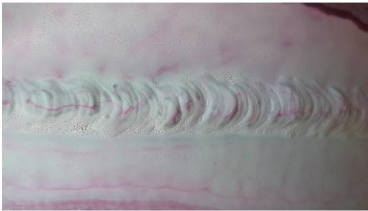
Obrázek 14 - penetrační zkouška na vzorku svařeném metodou GMAW
