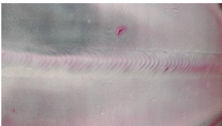
Obrázek 13 - penetrační zkouška na vzorku svařeném metodou GTAW
