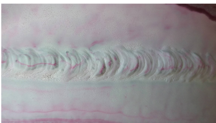
Obrázek 14 - penetrační zkouška na vzorku svařeném metodou GMAW
