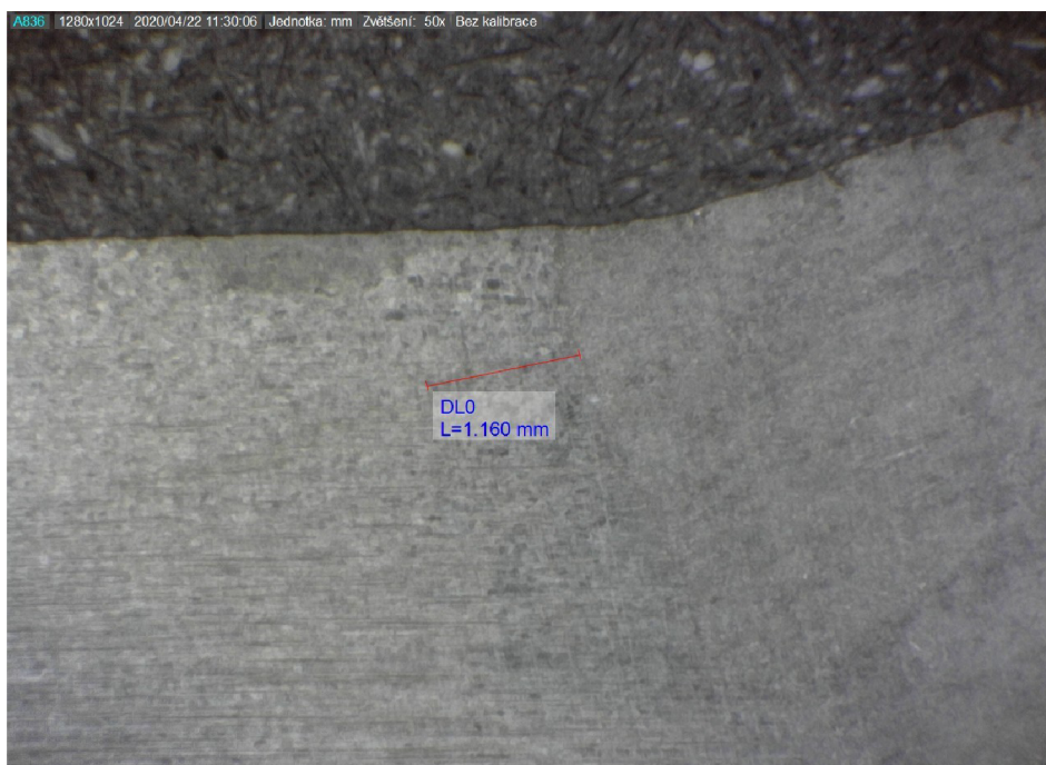
Obrázek 18 - šířka tepelně ovlivněné oblasti u vzorku svařovaného metodou GTAW
