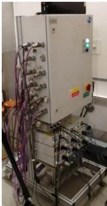
Obrázek 6.4 Stanice pro měření proudu a napětí DAQ4
