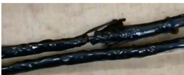
Obrázek 6.5 Vodič Cu 1,5 mm 2 po testu omezovací třídy 2
