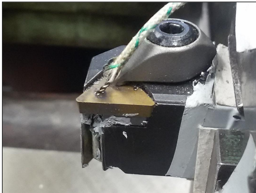
Obr. 17 Termočlánek stabilně zabudovaný na vyměnitelné břitové destičce.
