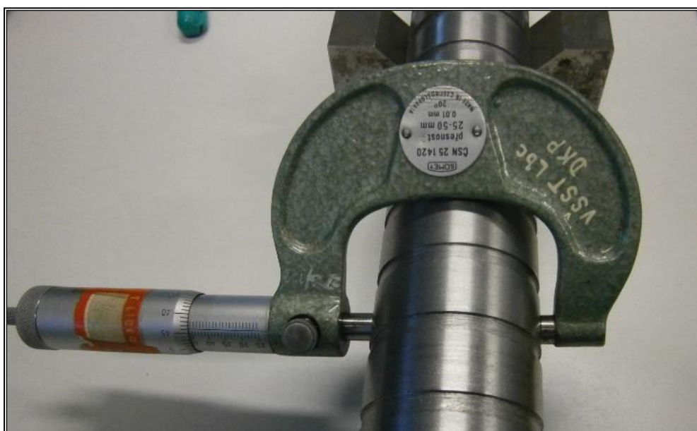
Obrázek 28 Měření rozměrové přesnosti pomocí ručního mikrometru.
