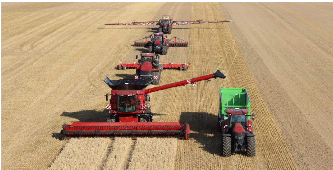
Obrázek 8: Příklad mechanizační linky pro CTF v rastru 12 metrů (Beneš, 2018b)
