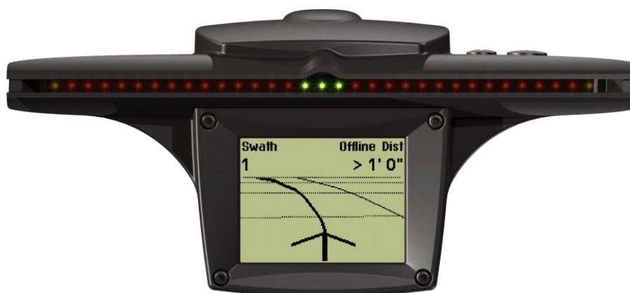
Obrázek 5: Světelná lišta Trimble EZ-Guide Plus Lightbar s displejem (Leading Farmers, 2019)
