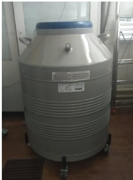
Obrázek 12: Nádoba s kapalným dusíkem na uchovávání vzorků. Foto: K. Dobešová
