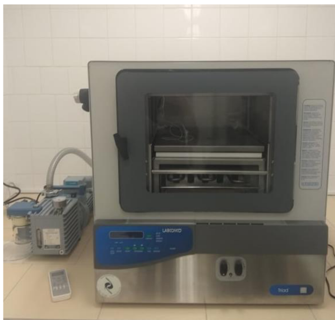
Obrázek 10: Lyofilizační přístroj z laboratoře VÚRV v Praze. Foto: K. Dobešová
