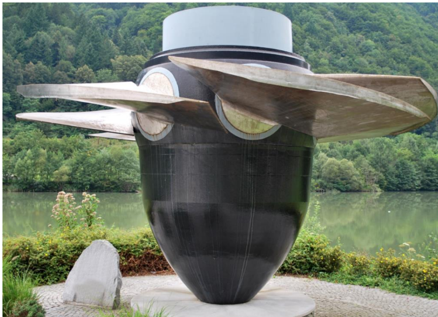
Obr. 4 Oběžné kolo Kaplanovy turbíny [3]
