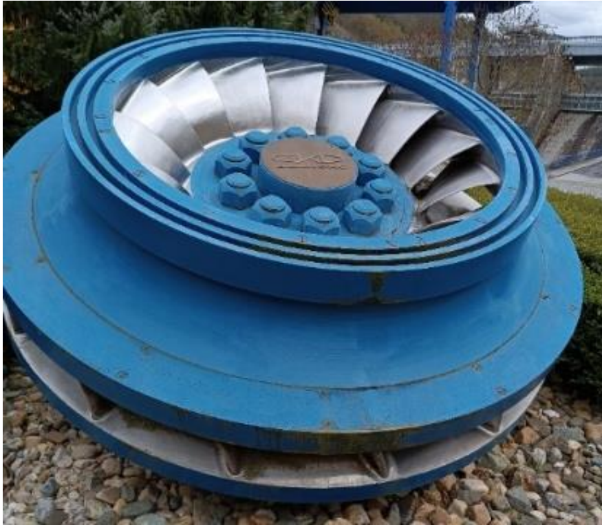
Obr. 1 Oběžné kolo Francisovi turbíny v areálu vodní elektrárny Štěchovice [vlastní]
