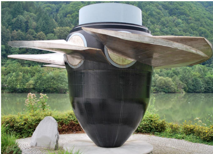
Obr. 4 Oběžné kolo Kaplanovy turbíny [3]
