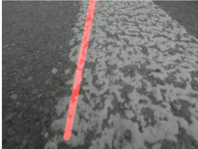
Obr. 4-8 Přímka vytvořená metodou nejstrmějšího gradientu
