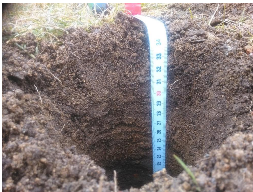
Obr. č. 7: Prázdný vrt pro infiltrační zkoušku (zdroj: autor).
