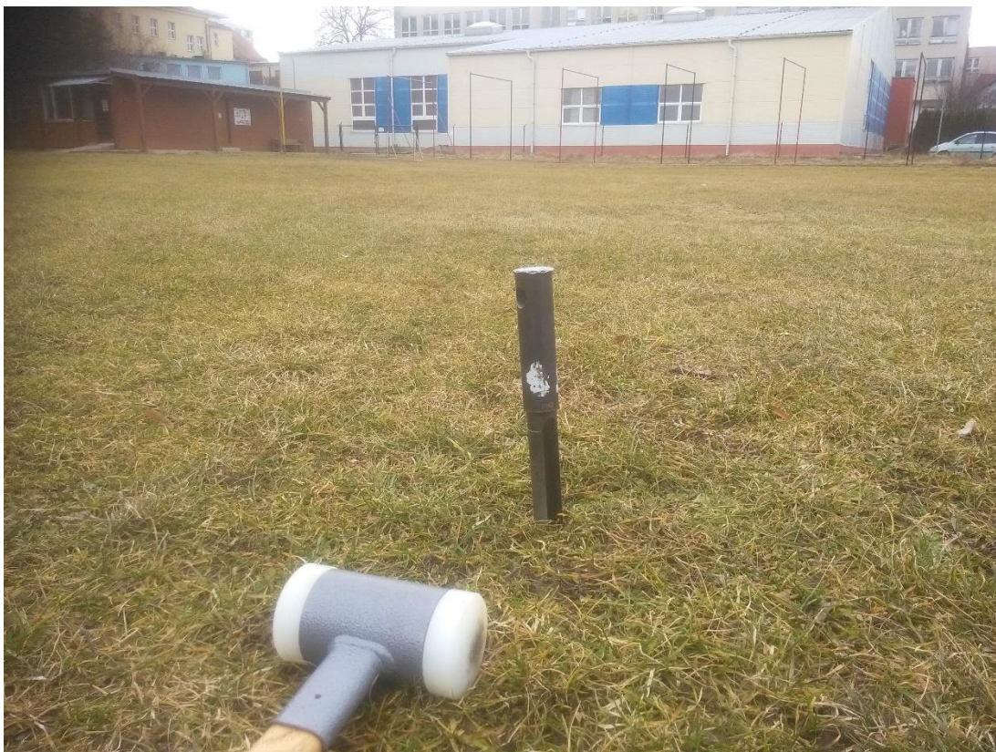
Obr. č. 3: Zatlučená sondýrka (zdroj: autor).
