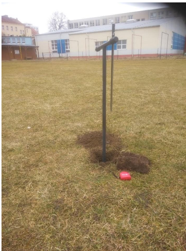
Obr č 6: Vyvrtaná sonda pro terénní infiltrační experiment (zdroj: autor).
