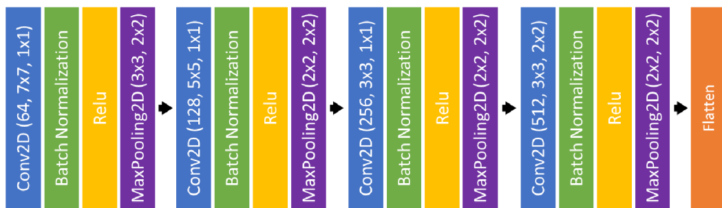
Obr. 3.10: Struktura konvoluční vrstvy základního modelu
