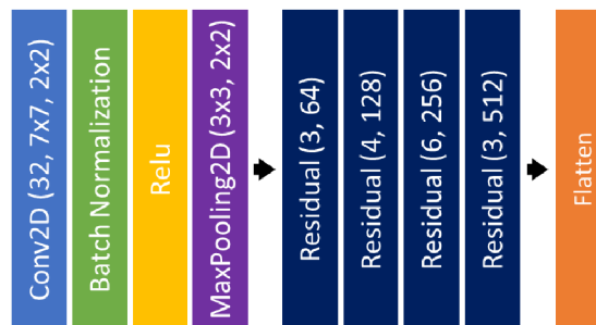
Obr. 3.13: Struktura upraveného modelu ResNet50
