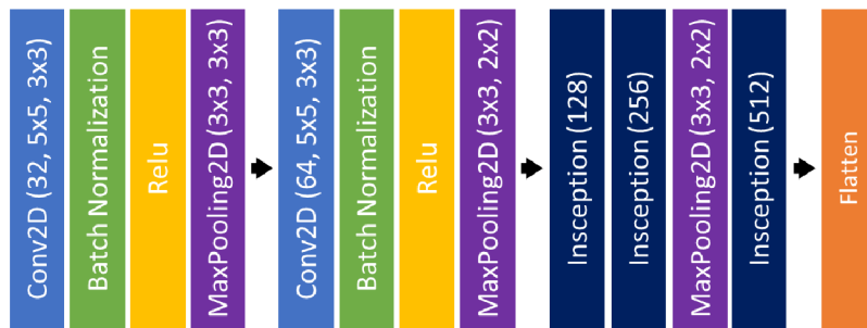
Obr. 3.15: Struktura navrženého modelu GoogLeNet
