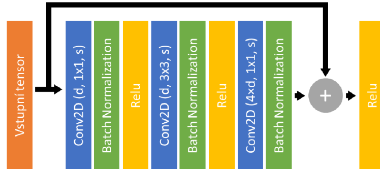
Obr. 3.12: Struktura Residuálního bloku větších modelů ResNet
