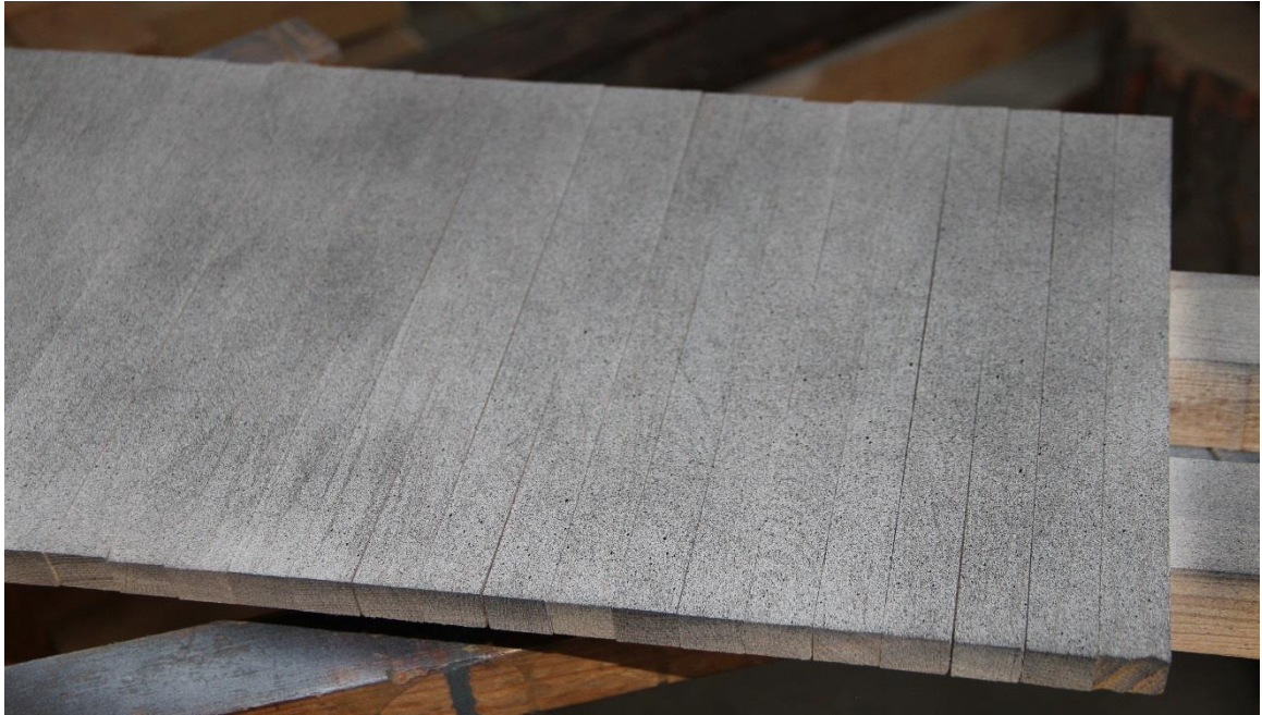
Obr. 4-1 Unikátní, náhodně skvrnitý vzor, tzv. „speckle pattern“.
