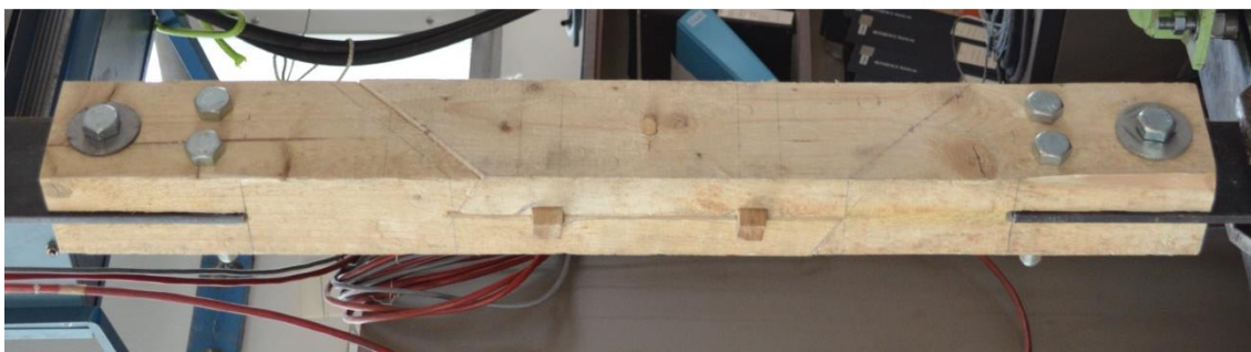
Obr. 3-11 Plátový spoj s podkosenými šikmými čely zajištěný dvěma hmoždíky a jedním kolíkem (foto Kunecký).
