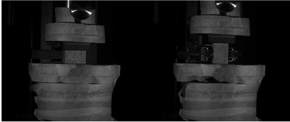
Obr. 4-4 Tlakové zatížení napříč (vlevo) a podél (vpravo) vláken.
