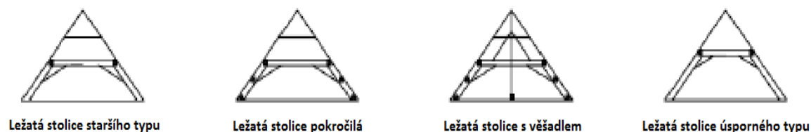
Obr. 3-4 Typy krovů vaznicové soustavy (Vinař 2010)
