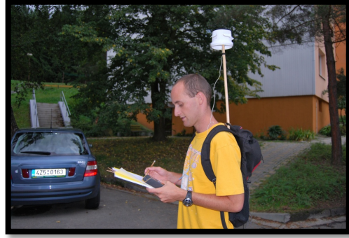
Obr. 4 Instalace teplotního čidla pro automobilové mobilní měření (vlevo) a ukázka pěšího mobilního měření (vpravo) (Navrátil 15. 6. 2011; 25. 8. 2012)
