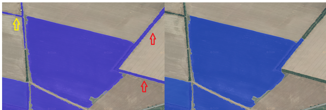
Obrázek 26: Ukázka funkce algoritmu pro rozdělení mostů. Na obrázku je vidět pole, ze kterého vycházejí remízy klasifikované do stejné třídy. Ty jsou algoritmem odstraněny.
