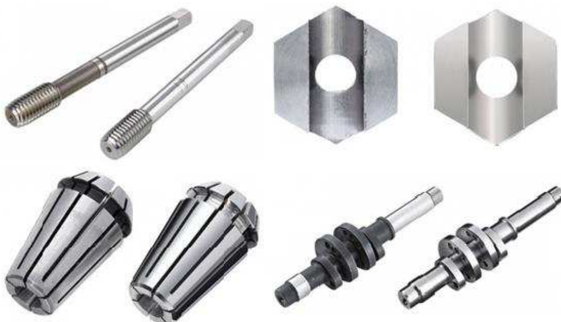
Obr. 13: Vliv technologie omílání na různé součásti (součást vlevo z dvojice je před omíláním, součást vpravo je po omílání) [14].
