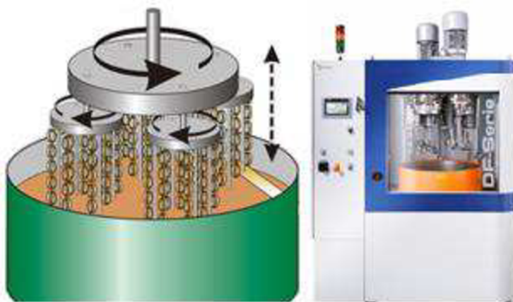
Obr. 18: Schéma vlečného omílání (vlevo) [17]; stroj pro vlečné omílání (vpravo) [14].
