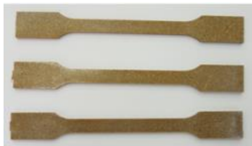
Obrázek 20 Zkušební tělesa typu 1B dle ČSN EN ISO 527.
