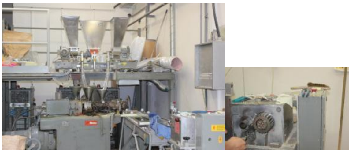
Obrázek 18 Jednošnekový extrudér BUSS MDK 46 s dávkovacím zařízením, chladicí vanou a granulovačkou (vlevo), nože granulovačky (vpravo).
