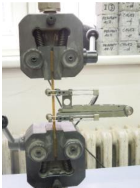
Obrázek 12 Testovací zařízení Testometric M350-20CT s externím tenzometrem.
