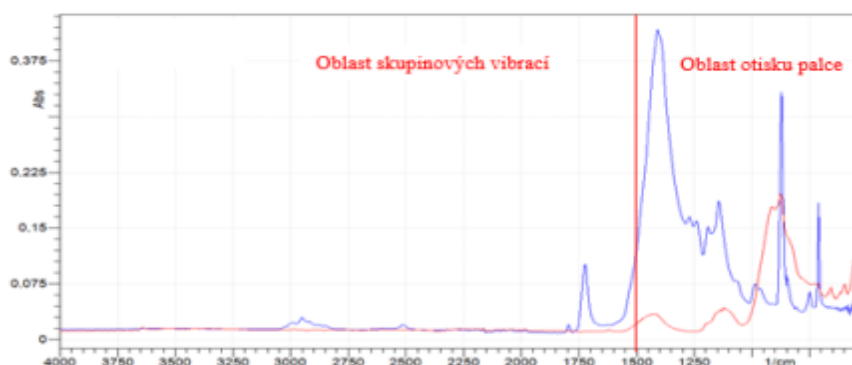
Spektrogram 4 Příklad infračerveného absorpčního spektrogramu označující oblast skupinových vibrací polymerů a oblast otisku palce.
