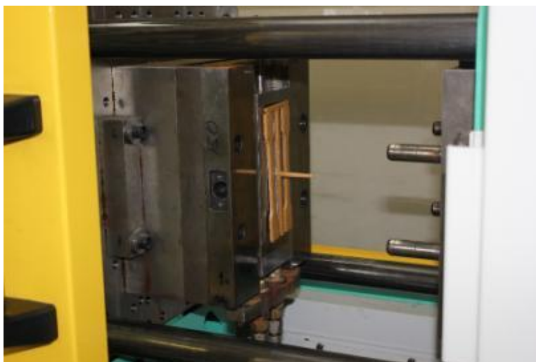
Obrázek 19 Forma vstřikolisu Arburg s výliskem referenčních zkušebních těles.
