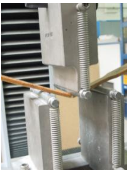
Obrázek 13 Zatěžování ohybem na testovacím zařízení Testometric M350-20CT.
