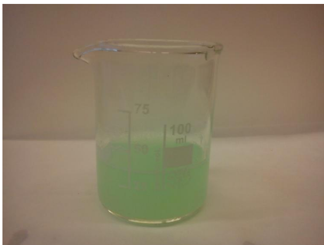
Obr. 4: koloidní částice hydroxidu nikelnatého při použití želatiny
