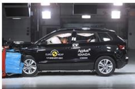
1. Škoda Karoq: Čelní přesazený náraz vozidla v rychlosti 64 km/h do deformovatelné bariéry
