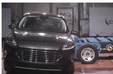
3. Ford Kuga: Boční náraz do boku vozidla vozíkem rozjetým na rychlost 50 km/h.
