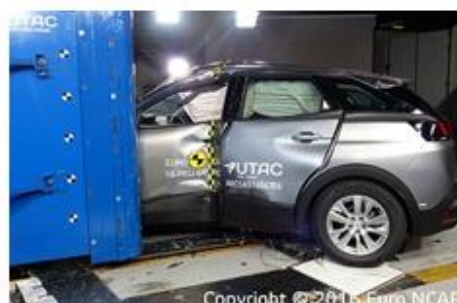
4. Peugeot 3008: Boční náraz vozu na sloupek (tzv. pole test) v rychlosti 29km/h.
