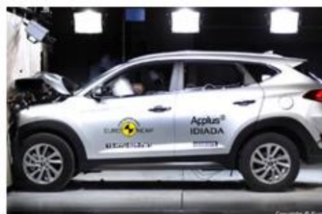
2. Hyundai Tucson: Čelní náraz plnou šířkou vozidla v rychlosti 50 km/h do nedeformovatelné bariéry.
