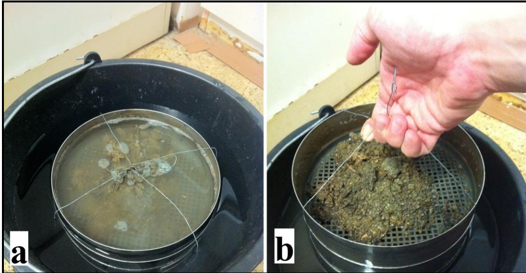
Obr. 12: Test stability agregátů ručním praním. (a) zatopení vzorku, (b) odvodnění vzorku.
