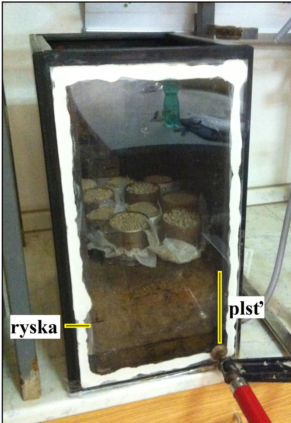
Obr. 18: Aparát pro měření retence vody.
