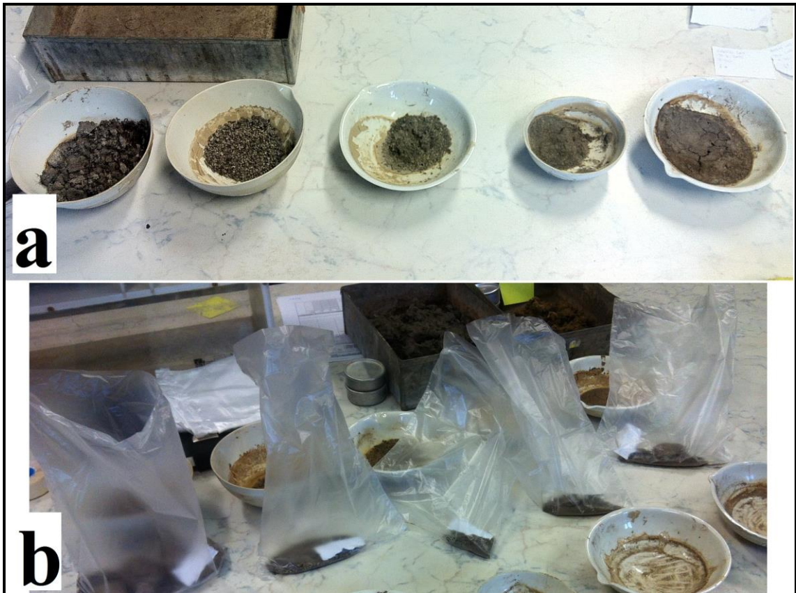
Obr. 14: Vzorok stability agregátů po vyndání z pece – od nejhrubších po nejjemnější (a) a po přesypání do igelitových pytlíků (b).
