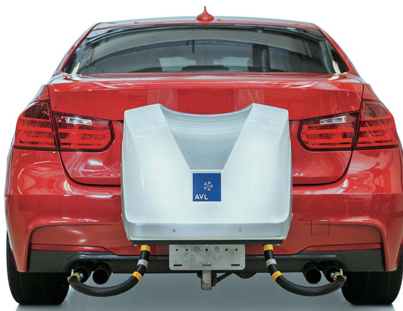
Obr. 10 Vozidlo vybavené PEMS [1]
