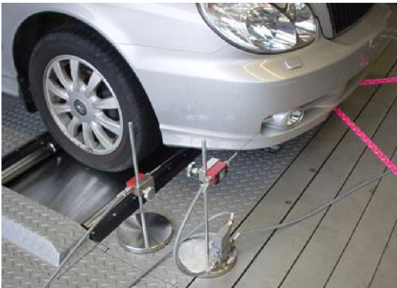
Obr. 1 Jednoválcový dynamometr (vlevo) a dvouválcový dynamometr (vpravo) [1, 4]
