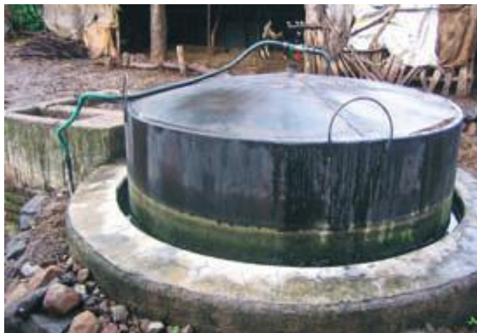
Obrázek 9 Příklad použití jednoduchého Gobar fermentoru v Indii [53]
