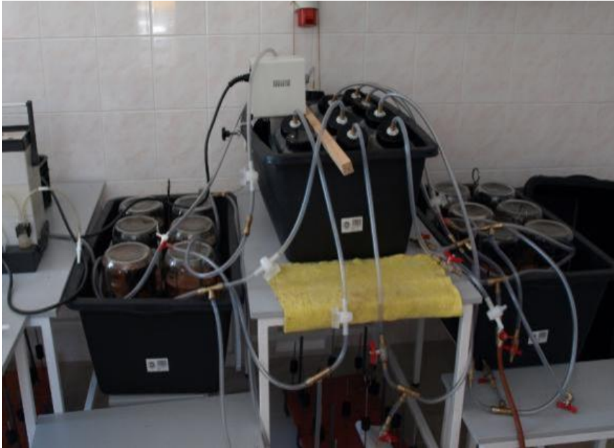
Obrázek 10 Laboratorní zařízení pro měření produkce bioplynu, nahoře jsou fermentory a dole plynojemy
