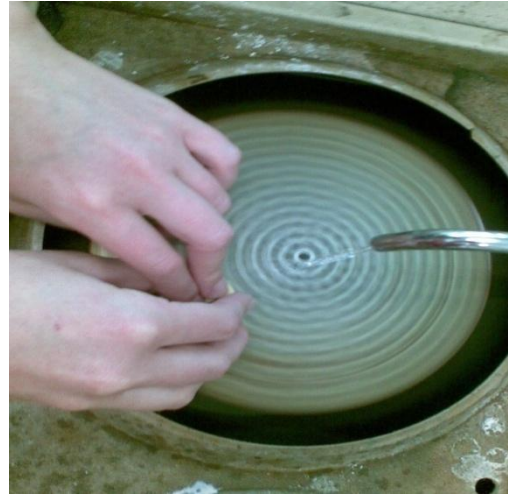
Obr. 19 Leštění vzorků na kotouči
