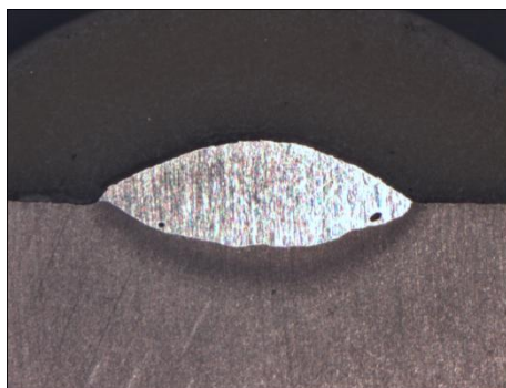
Obr. 11 Makrostruktura návarových housenek (vzorek 15.2 při zvětšení \times 3,5 )
