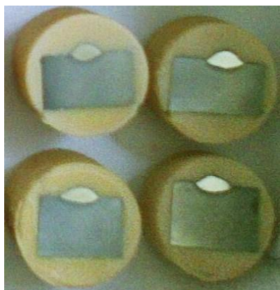
Obr. 9 Vzorky 4 vyleštěných příčných řezů návarů, zalité do akrylátové pryskyřice
