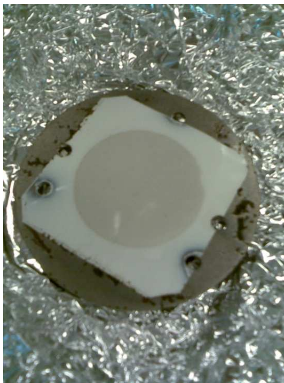
Fotografie 2: POCIS po oddělení těsnícího kovového kroužku
