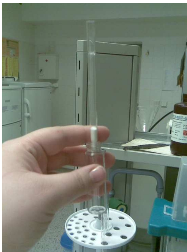
Fotografie 6: Aparatura na odchyení zbytkové vody pomocí bezvodého síranu sodného
