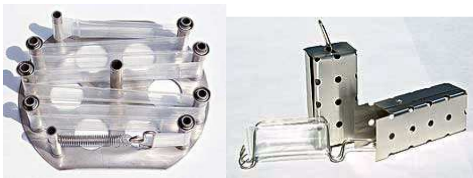
Obr. 7: Držáky různého provedení pro expozici SPMDs [29]
