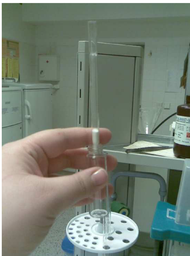
Fotografie 6: Aparatura na odchyčení zbytkové vody pomocí bezvodého síranu sodného
