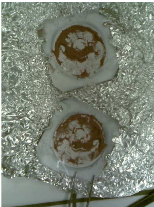
Fotografie 3: Sorbent vzorkovače POCIS na membráně
