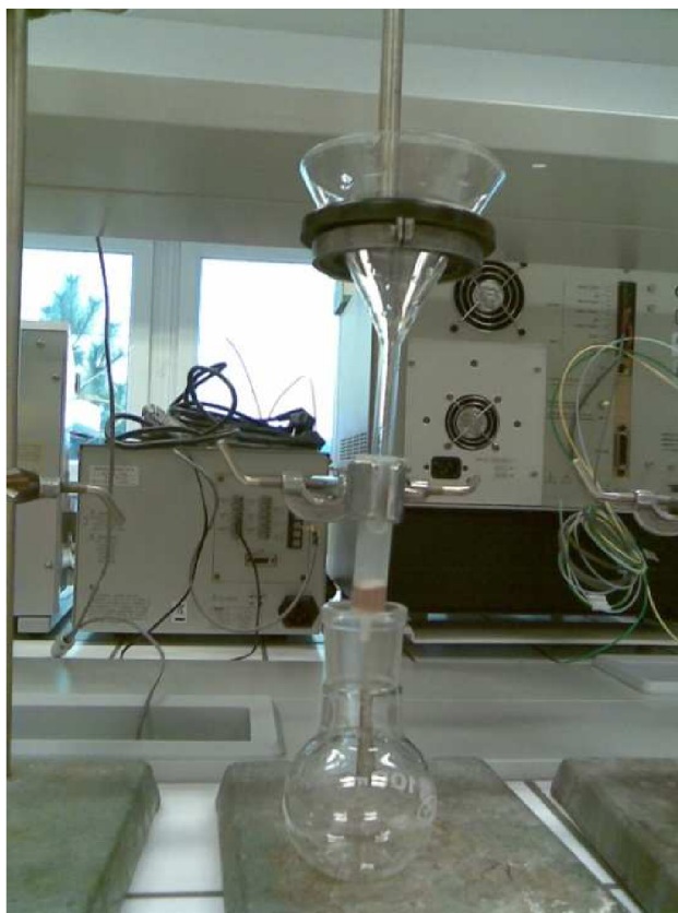
Fotografie 5: Aparatura připravená na eluci směsí rozpouštědel
