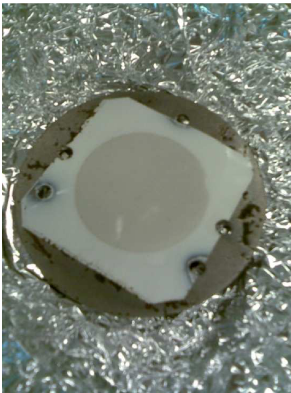
Fotografie 2: POCIS po oddělení těsnícího kovového kroužku
