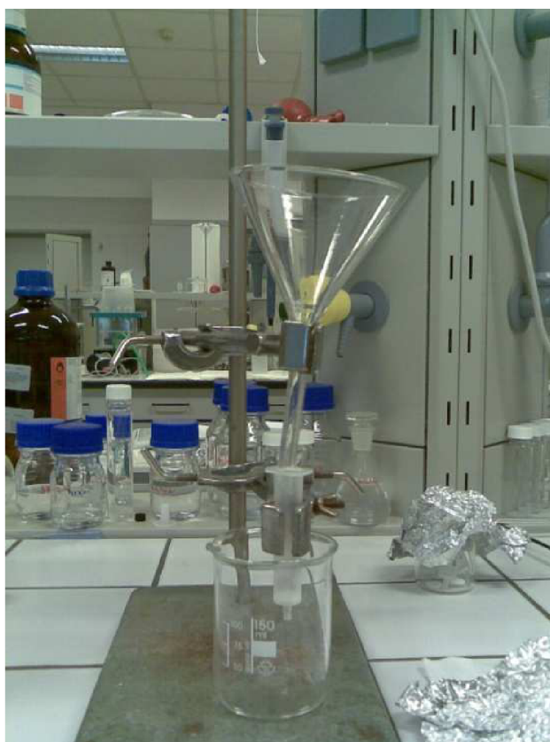
Fotografie 4: Aparatura na přenesení sorbentu do kolonky
