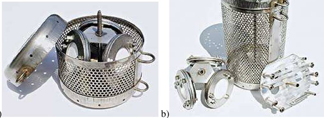
Obr. 11: a) Nosič tří disků POCIS v malém koši; b) Velký koš na vzorkovače, v popředí vzorkovače POCIS a SPMD na nosičích [39]
