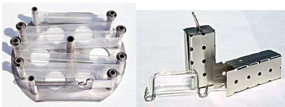
Obr. 7: Držáky různého provedení pro expozici SPMDs [29]
