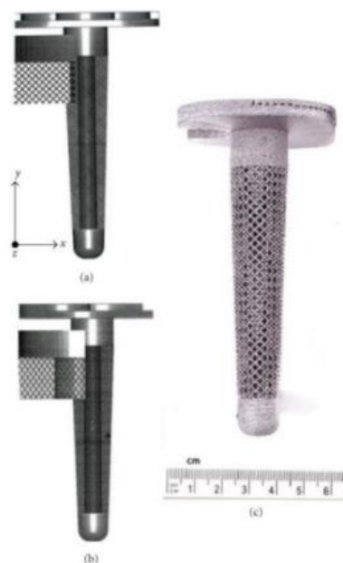
Obr. 2.2 Síťovaná struktura komponenty vyrobené technologií EBM [13].
