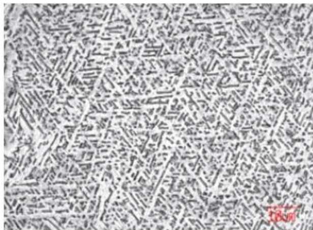
Obr. 3.4 Mikrostruktura materiálu Ti6Al4V, zvětšení 1 000x [23].
