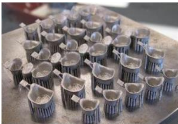
Obr. 2.6 Dentální náhrady vyrobené DMLS technologií [10].
