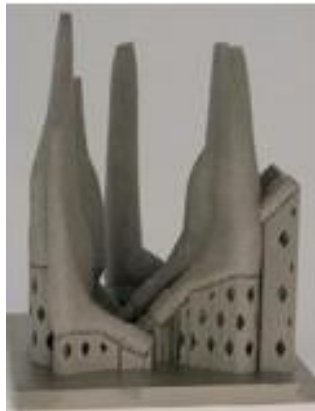
Obr. 2.3 Kyčelní stopka vyrobená technologií EBM [8].
