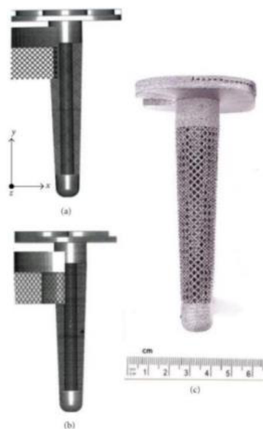
Obr. 2.2 Síťovaná struktura komponenty vyrobené technologií EBM [13].
