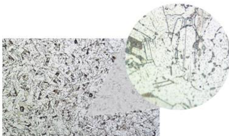
Obr. 3.10 Vertikální průřez materiálem Titanium Grade 2, zvětšení 50x, 500x [26].
