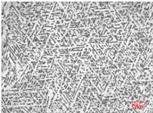
Obr. 3.4 Mikrostruktura materiálu Ti6Al4V, zvětšení 1 000x [23].
