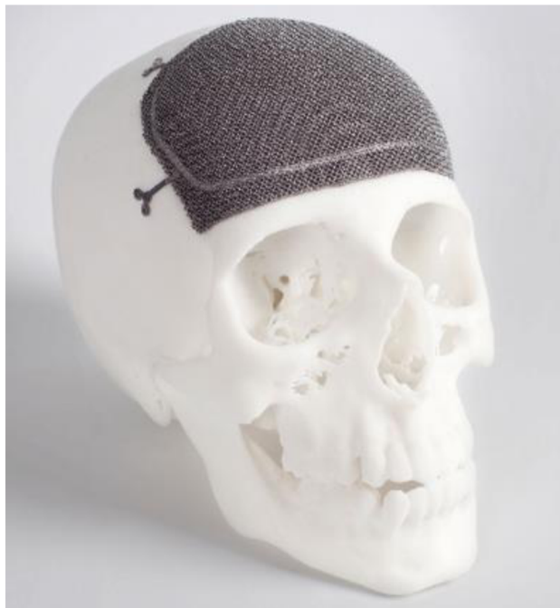
Obr. 2.5 Lebeční implantát vyrobený společností Arcam [7].
