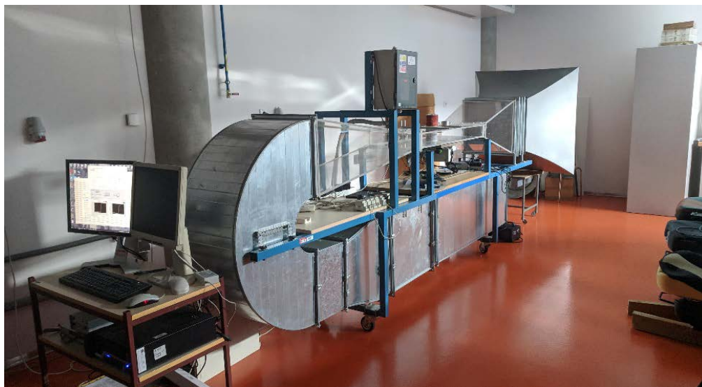
Obrázok 23 Aerodynamický tunel na Katedre odevníctva
