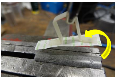
Obr. 28: Upnutí vzorku pěnového těsnění Zdroj: Vlastní
