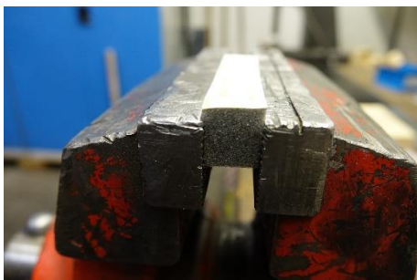
Obr. 29: Uchycení těsnění v čelistech Zdroj: Vlastní
