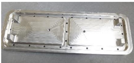
Obr. 1: Inovovaný přípravek pro lepení těsnění na klimatizační jednotku Zdroj: Vlastní
