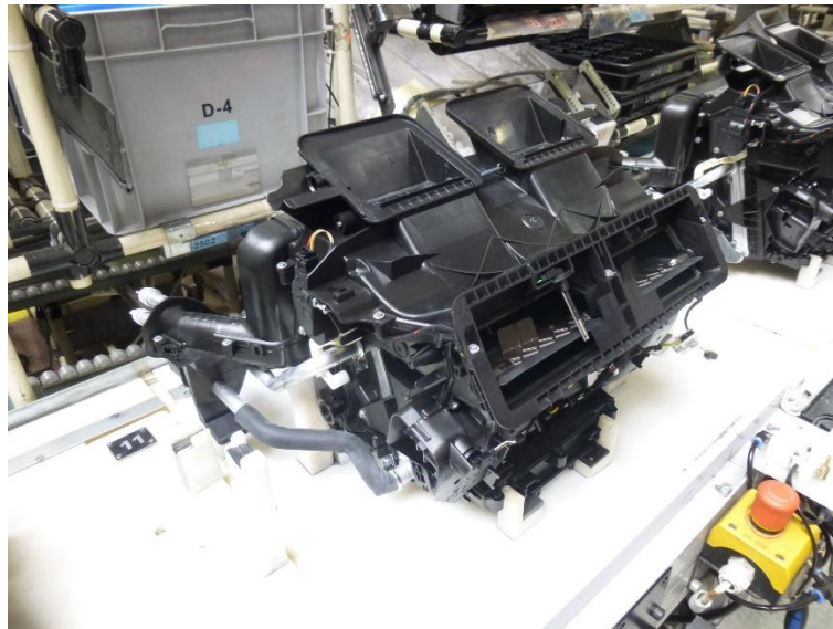
Obr. 2: Výrobní linka klimatizačních jednotek Zdroj: Vlastní
