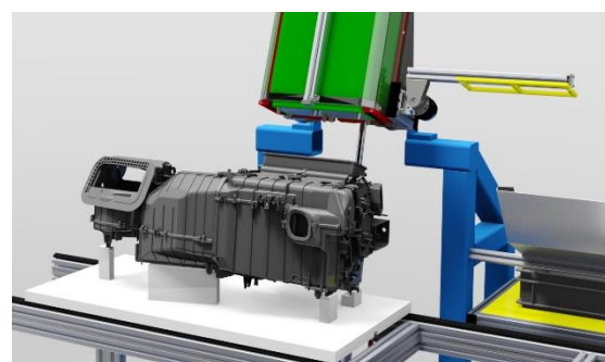
Obr. 39: Postup aplikace těsnění – I Zdroj: Vlastní
