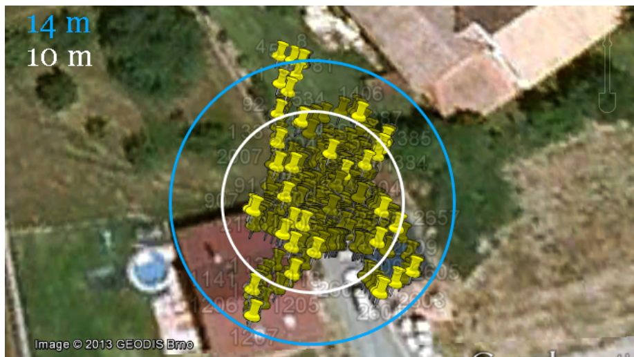
Obrázek 4.11: Test přesnosti GPS souřadnic z konstantní pozice
